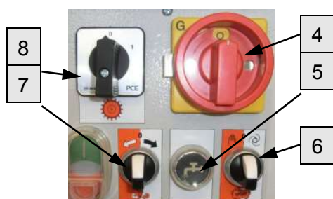
Рис. 106: Главный поворотный выключатель
