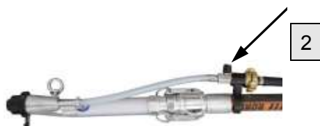
Рис. 65: Открытие воздушного крана
