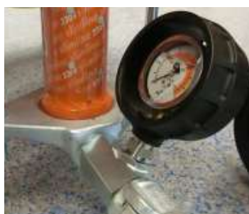
Рис. 48: Манометр давления раствора
