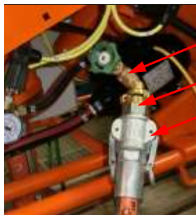
Рис. 58: Подготовка рукава для подачи раствора
