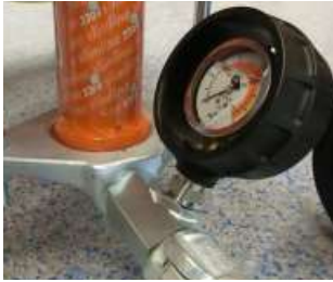
Рис. 30: Манометр давления раствора
