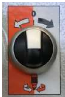
Рис. 13: Режимы эксплуатации привода насоса
