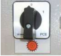
Рис. 87: Выключение подающего барабана
