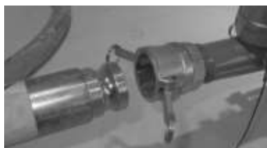
Рис. 25: Отсоединение шланга подачи раствора
