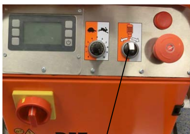
Рис. 44: Переключатель в положении "0"
