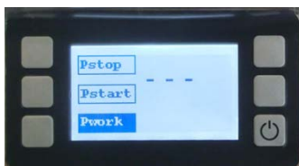
Рис. 28: Индикация при отсутствии давления
