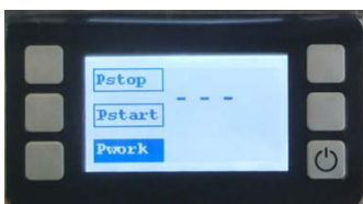
Рис. 54: Индикация при отсутствии давления
