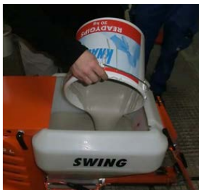
Рис. 24: Наполнение бункера для материала
