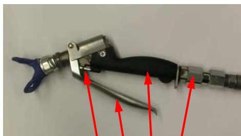
Рис. 21: Подсоединение растворного пистолета
