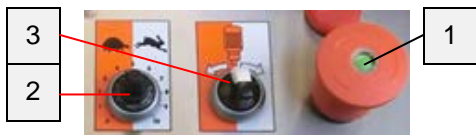
Рис. 36: Переключатель привода насоса
