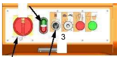
Рис. 19: Открытие воздушного клапана на распылителе
