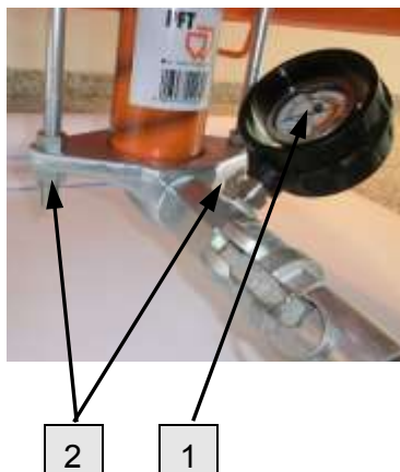
Рис. 69: Проверка давления раствора
