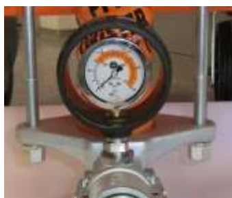
Рис. 44: Манометр давления раствора
