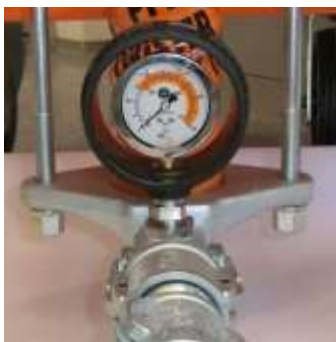
Рис. 27: Манометр давления раствора
